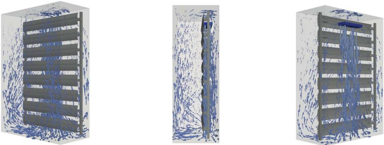
Figure 1 : Flux de circulation autour du châssis *AirSTREAM* avec le système de ventilation *AirBLOWER* installé
