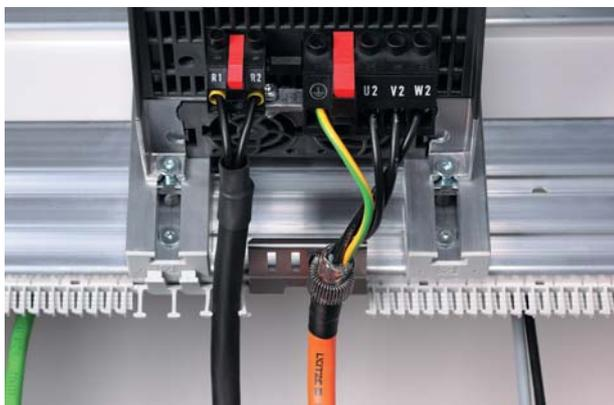
Eléments de reprises CEM pour les traverses **AirSTREAM**. Ils sont montés à la place d'un segment de peigne. Les câbles blindés peuvent être posés avec des pinces de blindage ou des pinces blindées directement devant le composant.
