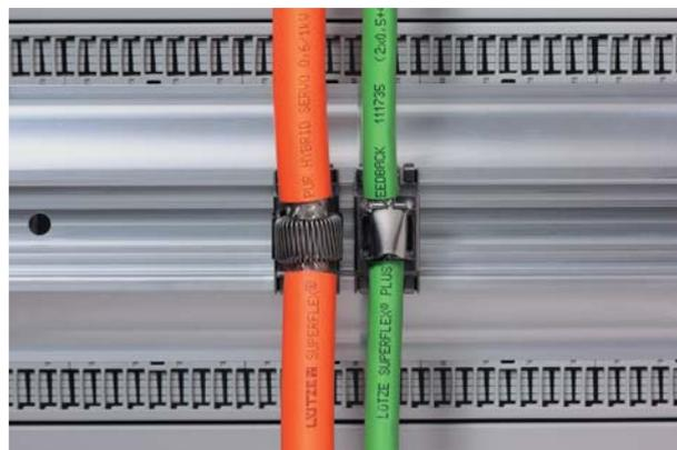
Elément de reprise CEM pour les rails Oméga DIN. Il peut être placé facilement sur un rail Oméga. Les câbles blindés peuvent être posés avec des pinces de blindage ou des pinces blindées directement devant le composant.
