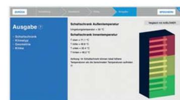
4ème étape : calcul et affichage différencié de la température intérieure de l'armoire de commande
