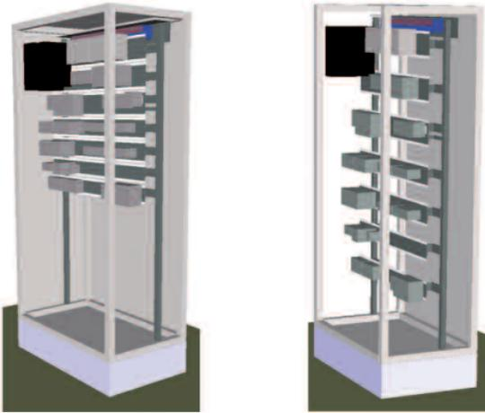
Abbildung 3.2.5.: Kompakte (links) und weniger kompakte (rechts) Bauteilanordnung
