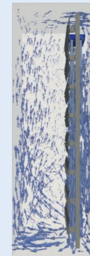
Zirkulationsströmung um AirSTREAM -Rahmen mit eingesetztem AirBLOWER -Lüftersystem
