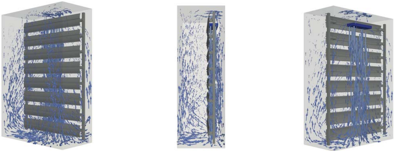
Abbildung 1: Zirkulationsströmung um AirSTREAM-Rahmen mit eingesetztem AirBLOWER-Lüftersystem
