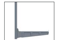
Montage der Konsole 50i am Stiel 2F/2FB mit T-Bolzen.
