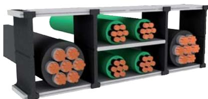
Für eine ausgewogene Gewichtsverteilung sorgen. Wenn mehr als ein schweres Kabel vorhanden ist, empfehlen wir die gleichmäßige Verlegung der schweren Kabel auf jeder Seite der Kette.
